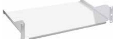
19"-Fachboden zum Einsatz von nicht verschraubtem Equipment. Aus lackiertem Stahlblech (Tiefe 250 oder 400 mm). Befestigung an vorderer 19"-Ebene. Einbaubar in allen Schränken bzw. einer minimalen Tiefe von 520 mm.
