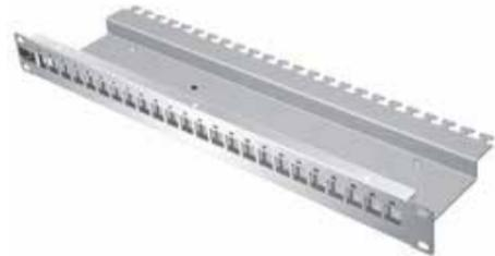
19"-Verteilerfeld für 24 Keystone-Module, Aufbau in zwei Ebenen für eine bündige Position der Module an der Front. Beschriftung 1-24, Kabelabfangung über eine integrierte Kabelabfangwanne zur Zugentlastung der Kabel mittels Kabelbinder.
