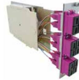
SKM ProfiLIGHT LAN-Baugruppenträger Modul, 3 HE zum Einschleiben in den 19"-Baugruppenträger. An die Moduleinheit sind die Spleißkassette und die Überlängenkassette verschraubt. Auf einer Seite wird gespleißt, auf der anderen Seite werden die Überlängen abgelegt. Bestückt mit SC Dx-Kupplungen und spleißfertig vorbereitet mit abgesetzten und in die Spleißkassette eingelegten Pigtails mit SC-Steckern.
