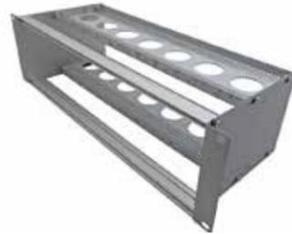
SKM ProfiLIGHT LAN-Baugruppenträger 19" 3 HE / 4 HE. Zur Aufnahme von 12 Kompaktmodulen 3 HE – 7 TE. Die Module werden senkrecht von vorne eingeschoben und an der Front verschraubt. Hohe Kapazität: 144 Fasern bei 12 Fasern pro Modul, 288 Fasern bei 24 Fasern pro Modul. Kabelzuführung von der Rückseite über Überlängenschublade bei 4 HE-Lösung oder direkt in das Modul bei 3 HE-Lösung. Bei 4 HE-Lösung Patchkabelmanager mit 5 Kabelführungsbügeln.
