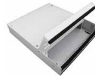
Consolidationpoint Gehäuse, ein Verteilergehäuse zur Wand-, Decken- und Bodenmontage. In drei verschiedenen Größen zur Aufnahme von 6 / 12 / 24 RJ45 Modulen oder LWL Kupplungen. Eingeteilt in Patchbereich mit Klappe zu öffnen und Verkabelungsbereich mit Deckel. Die ideale Lösung in Bereichen, wo eine Verteilung ohne Schrank umgesetzt werden muss.
