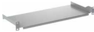
19"-Fachboden zum Einsatz von nicht verschraubtem Equipment. Aus lackiertem Stahlblech (Tiefe 200 mm). Befestigung an vorderer 19"-Ebene. Einsetzbar in allen Schränken.
