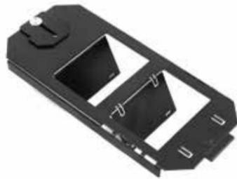
Universal Bodentankeinsatz zum Einbau in Bodentanks von verschiedenen Herstellern. Zur Aufnahme von 2 (GES 6) oder 3 (GES 9) Adapterplatten für RJ45 Module oder LWL Kupplungen. Optionale Kabelzugentlastung mit verstellbarer Position für bis zu 9 Einzelkabel.
