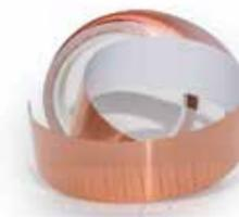
Das Kupferleitband wird eingesetzt, um einen sicheren 360°-Schirmkontakt zwischen Kabel und Modul zu erreichen. Das selbstklebende Kupferleitband wird am abgesetzten Kabelende über das Schirmgeflecht und um das Kabel geklebt und bildet dadurch einen sicheren und sauberen 360° Schirmabschluss.
