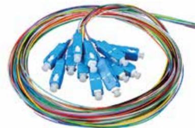
SKM ProfiLight Pigtails mit SC-Stecker und 900µ-Pigtailfaser als Bündel in 12 Farben nach DIN VDE 0888. Halogenfrei und leicht absetzbar für eine schnelle Verarbeitung. Für einen sicheren Transport und eine sichere Lagerung sind die Pigtail-Bündel im Polybeutel und auf Karton verpackt. Jedes Pigtail-Bündel wird inkl. Messprotokoll geliefert. Je nach Anforderung kann zwischen den Güteklassen entsprechend Grade B und C gewählt werden.
