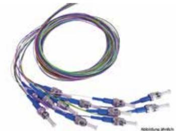
SKM ProfiLight Pigtails mit FC-Stecker und 900µ-Pigtailfaser als Bündel in 12 Farben nach DIN VDE 0888. Halogenfrei und leicht absetzbar für eine schnelle Verarbeitung. Für einen sicheren Transport und eine sichere Lagerung sind die Pigtail-Bündel im Polybeutel und auf Karton verpackt. Jedes Pigtail-Bündel wird inkl. Messprotokoll geliefert. Je nach Anforderung kann zwischen den Güteklassen entsprechend Grade B und C gewählt werden.
