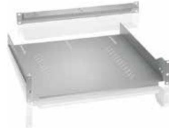
19"-Fachboden zum Einsatz von nicht verschraubtem Equipment. Aus lackiertem Stahlblech (Tiefe 470 / 600 mm). Befestigung an vorderer und hinterer 19"-Ebene. Einbaubar in Schränken mit einer minimalen Tiefe von 600 / 800 mm.
