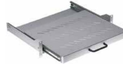
Ausziehbarer Fachboden 19» zum Einsatz von nicht verschraubtem Equipment. Aus lackiertem Stahlblech (Tiefe 470 mm). Befestigung an vorderer oder an vorderer + hinterer 19"-Ebene. Einbaubar in Schränken mit einer minimalen Tiefe von 470 mm.
