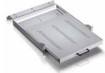
Ausziehbarer Fachboden 19» zum Einsatz von nicht verschraubtem Equipment. Aus lackiertem Stahlblech (Tiefe 600 mm). Befestigung an vorderer + hinterer 19" Ebene. Einbaubar in Schränken mit einer minimalen Tiefe von 800 mm und 1000 mm.
